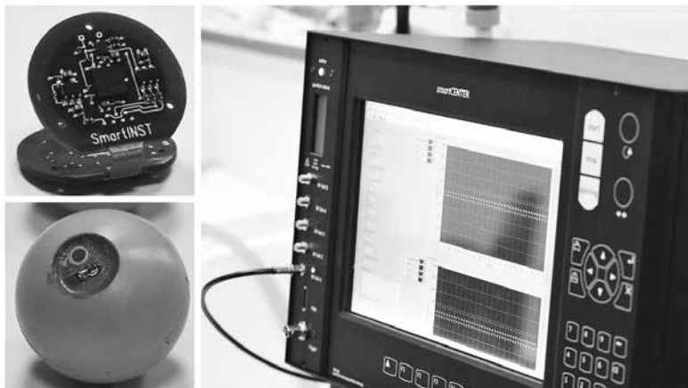
Une smartPART (intérieur et extérieur) et la centrale d'acquisition et de pilotage smartCENTER
